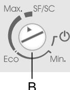
Чтобы включить прибор, поверните ручку В в направлении к Max. Чтобы выключить прибор, установите ручку так, чтобы знак треугольника на ручке был в положении  $\Phi$  (прибор выключен, но находится под напряжением).
