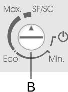
Для включения функции «Быстрое замораживание» установите ручку В так, чтобы знак треугольника на ручке был в положении **SF/SC**.
