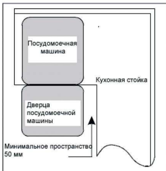
РИСУНОК 2 Минимальное пространство, необходимое для открытия двери.
