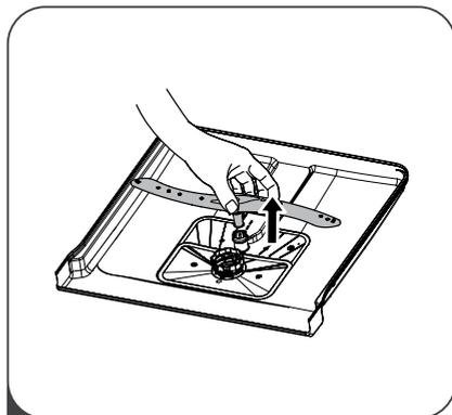
2 Чтобы снять нижнее распылительное коромысло, потяните его вверх.
