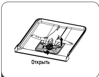
1 Удерживая фильтр грубой очистки, поверните его против часовой стрелки, чтобы освободить фильтр. Поднимите фильтр вверх и извлеките его из посудомоечной машины.
