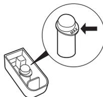
Установите дополнительную емкость 3 (входящую в комплект поставки машины) в отделение 1.
